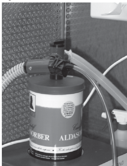
Figuur 7: "Isofluraan adsorber", waarover de afgezogen lucht wordt geleid en het isofluraan uit de lucht aan koolstof adsorbeert.
